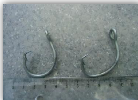
Déformation sur un hameçon circulaire
