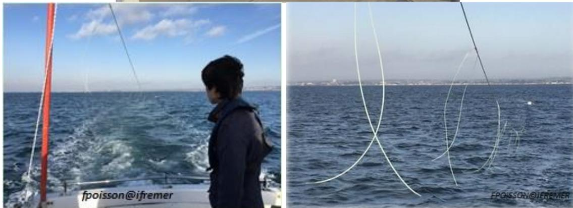
Figure 69. Ligne d'effarouchement construite par les étudiants du Lycée de la mer avec du matériel offert gracieusement par la société Seabird 100m de lignes d'effarouchement. (Tube photoluminescent – diamètre  $5\pm 0,2 \times 3,4\pm 0,2$  en PEHD).
