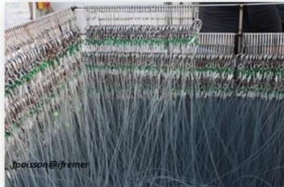
Figure 20 : Eléments d'une palangre semi-automatique : Enrouleur à entraînement hydraulique et avançons équipés d'agrafes stockés dans une caisse de rangement
